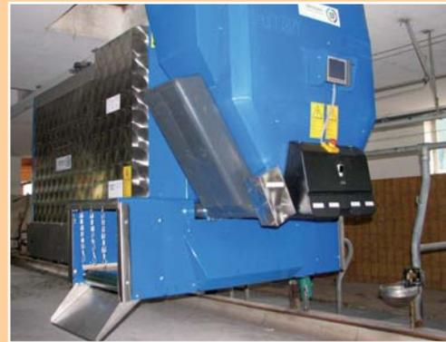
Combi Futterroboter mit separaten Kraftfutterboxen zum Ausdosieren von Rau- und Kraftfutter in einem Arbeitsgang
