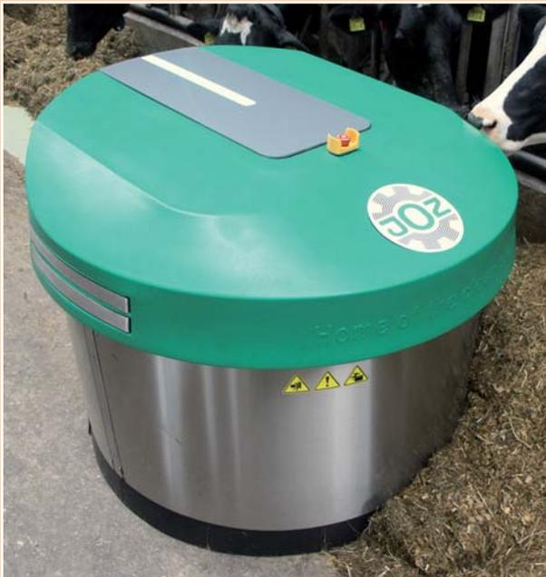
Das Futter auf dem Barn wird durch den Roboter regelmäßig nachgeschoben, dadurch haben die Tiere stets Zugang zu frischem Futter. Daraus ergeben sich folgende Vorteile:
