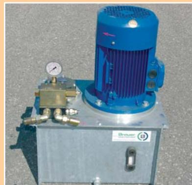
HYDRAULIKAGGREGAT versorgt gleichzeitig Druckzylinder und mehrere Zubringerbahnen, ein druckunabhängig arbeitendes, automatisches Umschaltventil schont die Anlage – da es nicht auf Höchstdruck umschaltet je nach Anlage 5,5 oder 7,5 kw - Motor
