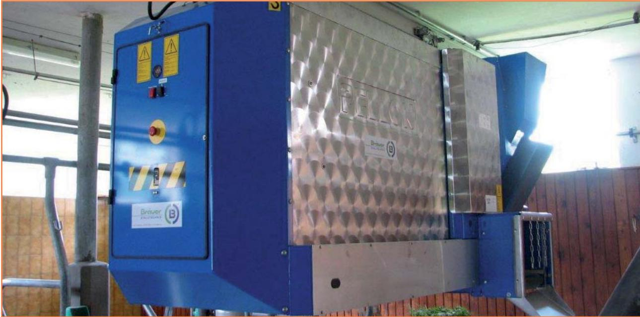
Der neue Laufstall Futterroboter verteilt die Futtermischung aus einer feststehenden Mischanlage an die Futtertische.
