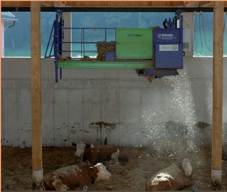
schienengeführte Einstreuanlage für ein optimales Einstreuergebnis in Tretmist-, Lauf- und Liegeboxenlaufställen
