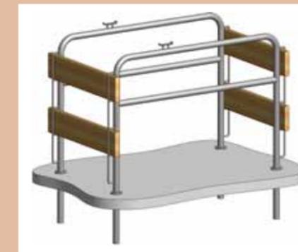
Untersuchungsstand zur sicheren Behandlung oder zur Besmung der Stuten
