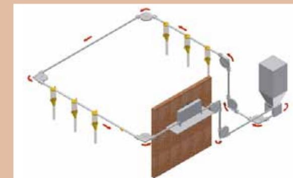
Mit automatischen Fütterungsanlagen kann das Kraftfutter gleichmäßig, auf den ganzen Tag verteilt abgegeben werden. Individuelle Mischungen von unterschiedlichen Komponenten (z. B. Zugabe von Medikamenten) sind sehr leicht möglich.
