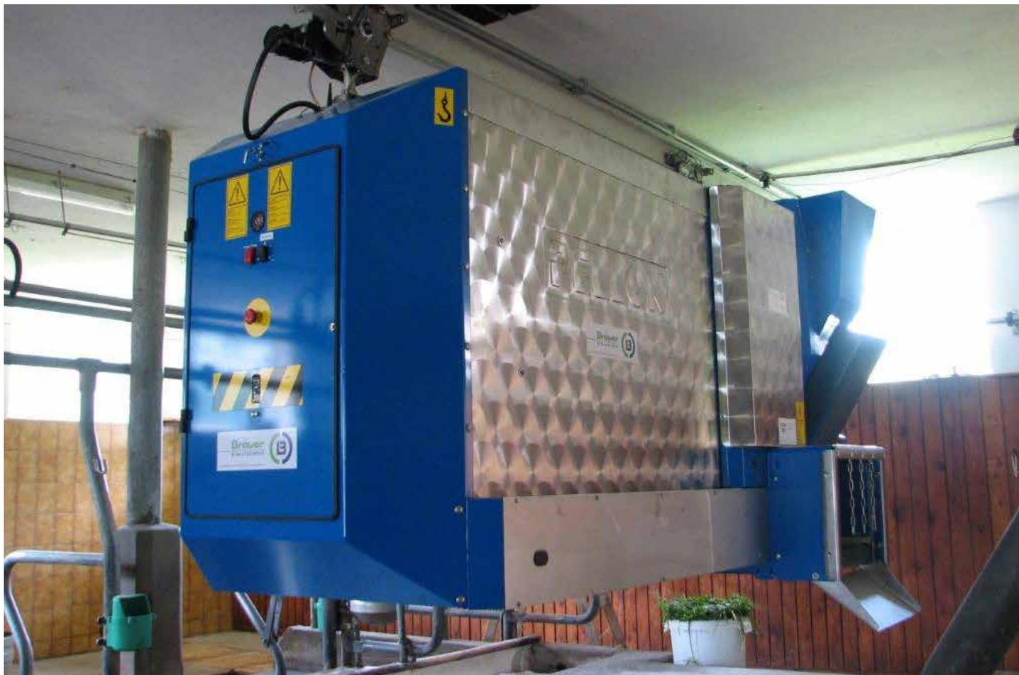
Der neue **LAUFSTALL FUTTERROBOTER** verteilt die Futtermischung aus einer feststehenden Mischanlage an die Futtertische.
