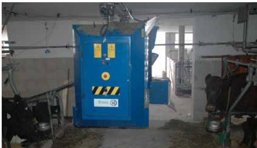
Der **COMBI FUTTERROBOTER** erstellt eine individuelle Ration und liefert diese an jede einzelne Kuh. Vom Prinzip her arbeitet der Combi Futterroboter wie der Kraftfutter-Roboter. Zusätzlich zum Kraftfutterbehälter ist hier auch ein Raufutterbehälter angebracht, so dass auch Silage individuell verteilt werden kann.
