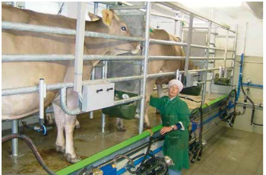
Standsäulen aus starkwandigen 2" Rohren, optimales Anpassen an Gefälle durch Teleskopfüße möglich, Nirosta-Trennbleche, mechanisch, halbautomatisch oder vollautomatisch mit pneumatischem Zylinder oder Vakuumzylinder möglich
