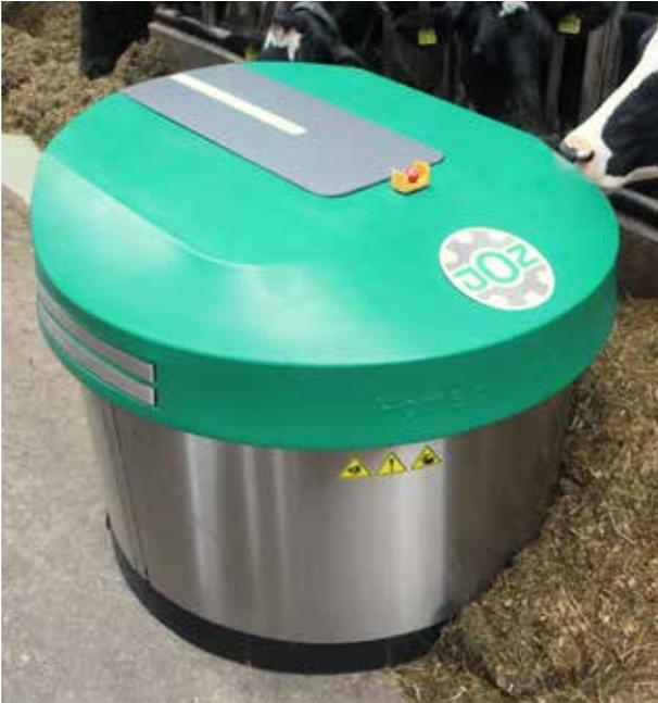
Das Futter auf dem Barn wird durch den Roboter regelmäßig nachgeschoben, dadurch haben die Tiere stets Zugang zu frischem Futter.
