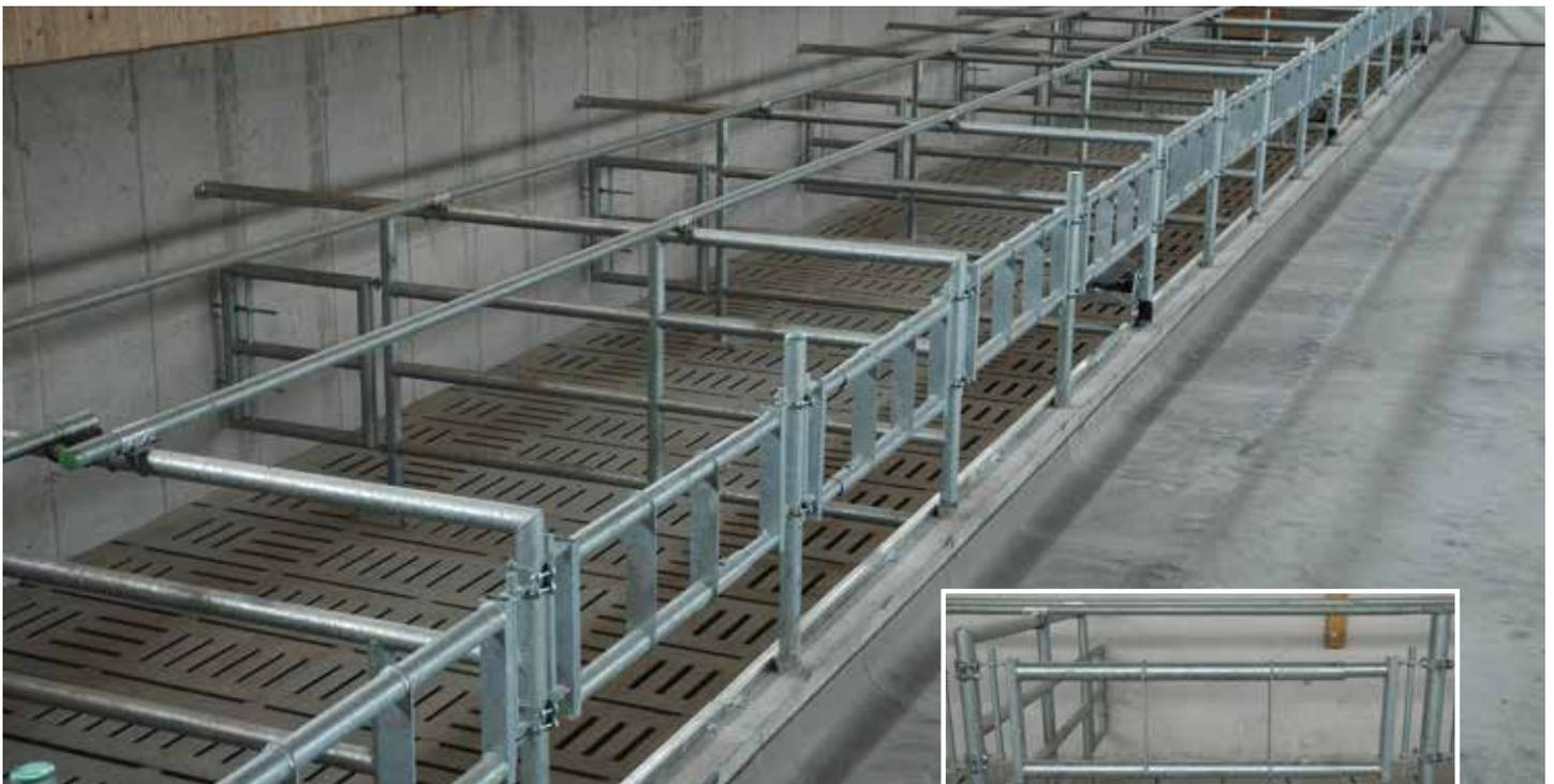
Boxen-Frontaustrieb über Futtertisch in 2 1/2" Nackenrohr-Trenngitter
