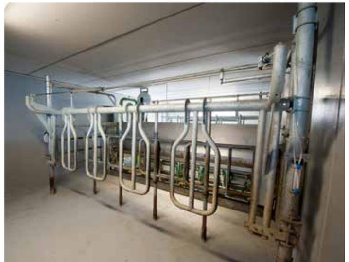
pneumatisch gesteuerter **SIDE BY SIDE** mit Ausgangsverriegelung
