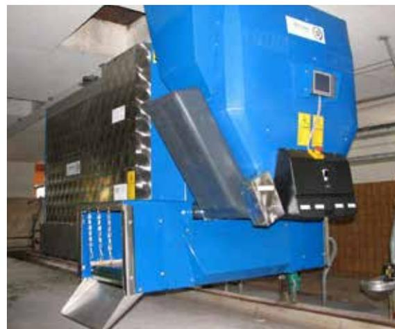
**COMBI FUTTERROBOTER MIT SEPARATEN KRAFTFUTTERBOXEN** zum Ausdosieren von Rau- und Kraftfutter in einem Arbeitsgang
