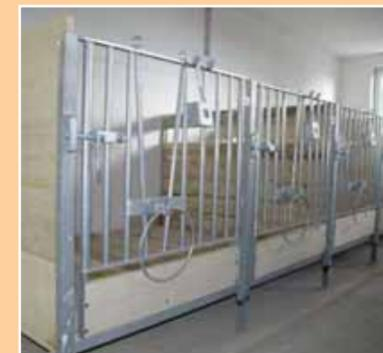
für die ersten Lebenswochen bis ca. 100 kg, starke Standsäulen aus UNP-Profilen, Trennwände aus Holz- oder PVC-Profilen, hochgestellter Rost möglich, serienmäßige Saugeimer- bzw. Eimerhalterung (klappbar)
