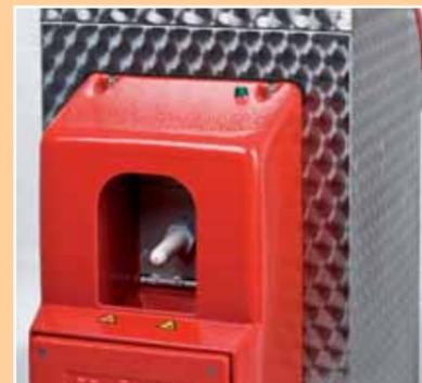
Die Saugereinheit befindet sich am Automaten. Durch ihre Konstruktion mit glatten Oberflächen bleibt sie länger sauber und lässt sich sehr leicht reinigen.
