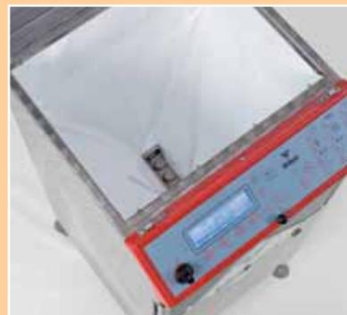
In dem geräumigen Pulverfach finden bis zu 35 kg Pulver Platz.
