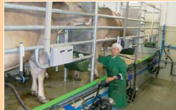
Standsäulen aus starkwandigen 2" Rohren, optimales Anpassen an Gefälle durch Teleskopfüße möglich, Nirosta-Trennbleche, mechanisch, halbautomatisch oder vollautomatisch mit pneumatischem Zylinder oder Vakuumzylinder möglich
