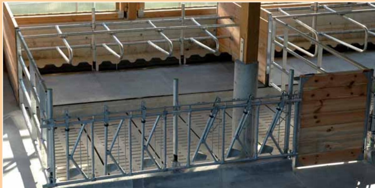
Ausführung in 1" oder 5/4" Rohren für Kälber, mit Türbeschlag zum Boxeneingang und Futtertisch, geräuscharm durch robuste PVC-Fallklappen und Überschubgummi an Schwenkstäben, Einzel- oder Gruppeneinsperrung, wahlweise Trogteiler mit aufschraubbaren Eimerhaltern
