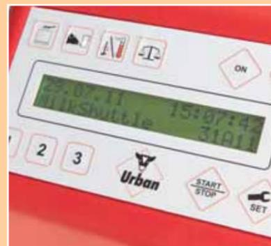
mit Anzeige der Soll- und Ist-Temperatur sowie der Zeiten für die Rührintervalle
