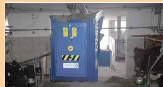
Der Combi Futterroboter erstellt eine individuelle Ration und liefert diese an jede einzelne Kuh. Vom Prinzip her arbeitet der Combi Futterroboter wie der Kraftfutter-Roboter. Zusätzlich zum Kraftfutterbehälter ist hier auch ein Raufutterbehälter angebracht, so dass auch Silage individuell verteilt werden kann.
