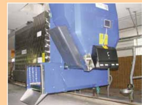
Combi Futterroboter mit separaten Kraftfutterboxen zum Ausdosieren von Rau- und Kraftfutter in einem Arbeitsgang
