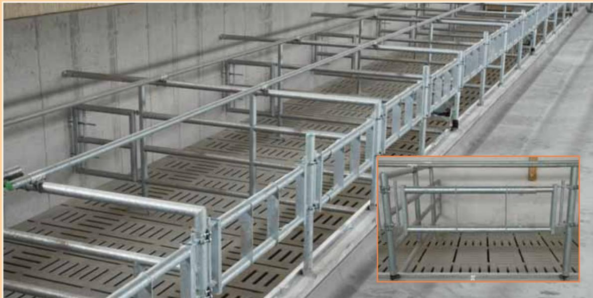
Boxen-Frontaustrieb über Futtertisch in 2 1/2" Nackenrohr-Trenngitter
