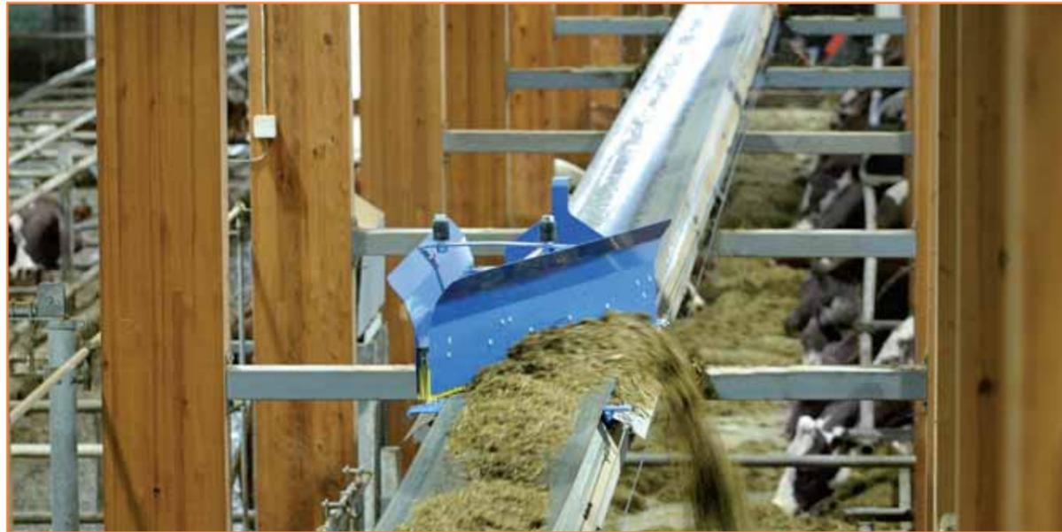
Die einfachste Art Futter aus dem Befüller oder einer feststehenden Mischanlage an das Tier zu bringen.
