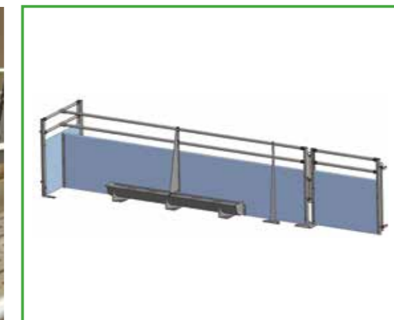
Doppelnirotrog mit Trennwandaussteifung und Ablassöffnung
