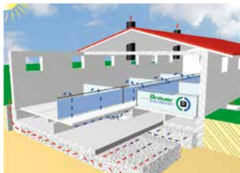
Abkühlung der Zuluft im Sommer um bis zu 20°C
