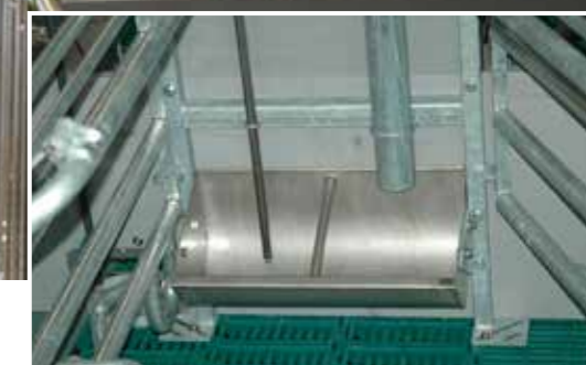
großvolumiger, sehr massiver Edelstahltrug mit Fressplatzteiler und Schnellablaufbahn
