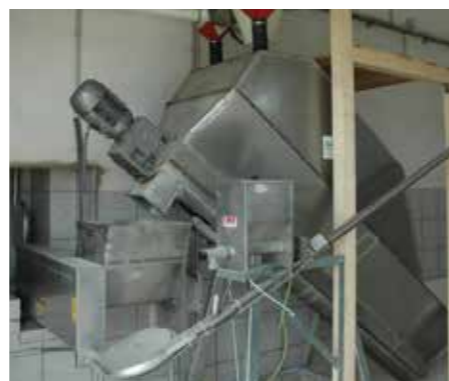
CCM-SCHRÄGMISCHER mit Wiegesystem
