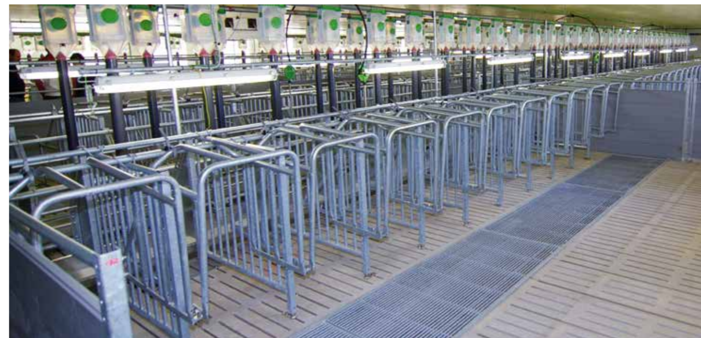
kombinierter Warte-/Deckstall für effektive Raumnutzung und Tierkontrolle
