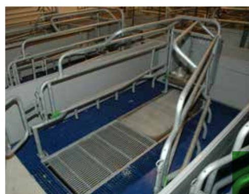
mit gewelltem Dreikanrost inklusive Koteinwurfschlitz
