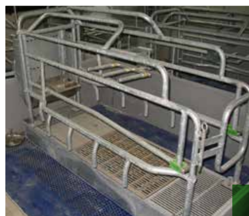
Der höhenverstellbare Liegebereich der Sau verhindert Ferkelverluste durch Erdrücken um 5 - 8%.
